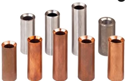
**GIUNTE.** Le giunte per cavo standard 4.8/4.9 mm sono fornite in Rame e Tubo Bonderizzato, con le estremità svasate da entrambe i lati per facilitare l'inserimento del cavo. Le misure standard fornite sono: 8x20 - 8x22 - 8x25 - 8x30 - 9x25 - 9x30 mm.
