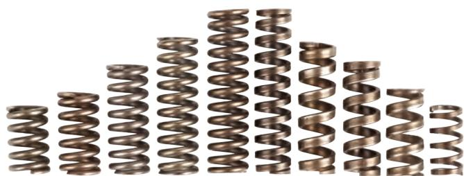
**MOLLE.** Le molle sono realizzate in acciaio al carbonio UNI EN 10270 nei diametri 1.30-1.40 mm e fornite nelle lunghezze Standard L.12-15-20-25-27-30 mm; a richiesta possono essere fornite misure speciali. Per fili diamantati plastificati e per macchine multifilo vengono realizzate molle con filo a sezione rettangolare 0.5x1.00 mm, 0.7x1.40 mm, 0.7x1.70 mm e 0.8x1.80 mm, con lunghezza e diametri a richiesta. Le molle sono fornite in confezioni da 5.000 pz.
