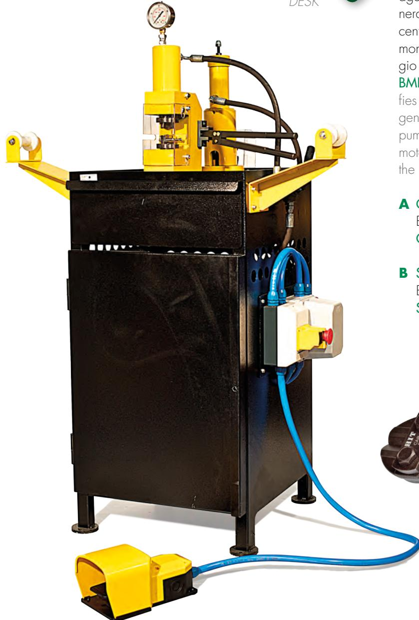
**BMF – BANCO DI MONTAGGIO FILO.** Il banco di lavoro agevola e semplifica l'operazione di assemblaggio e rigenerazione del "filo diamantato". Esso è composto da una centralina oleodinamica azionata da un motore elettrico monofase o trifase che comanda la pressa per il bloccaggio dei pressatori e la trancia per il taglio del cavo.
